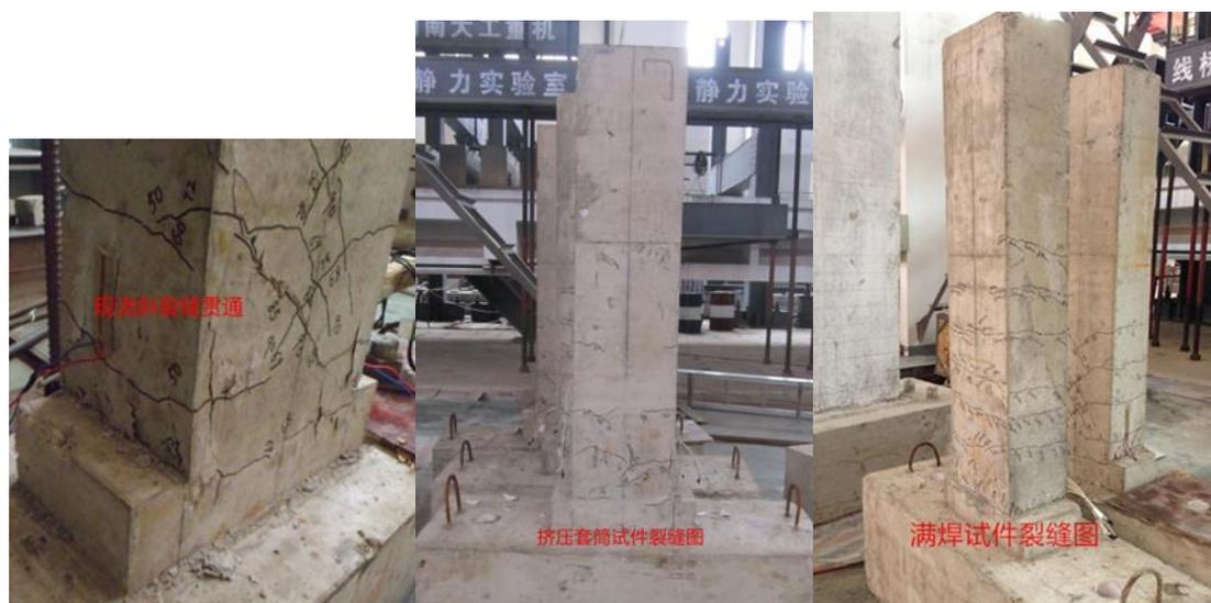
(a) 现浇试件斜裂缝
