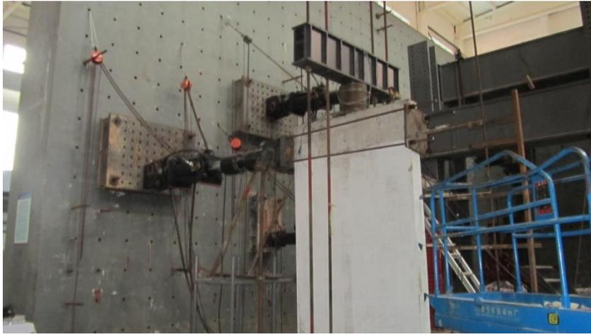
图3-3 剪力墙试件低周反复荷载加载装置
