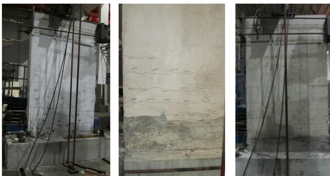
(a) HSW1 破坏时裂缝分布    (b) HSW3 作动器侧裂缝分布    (c) HSW5 破坏时裂缝分布
