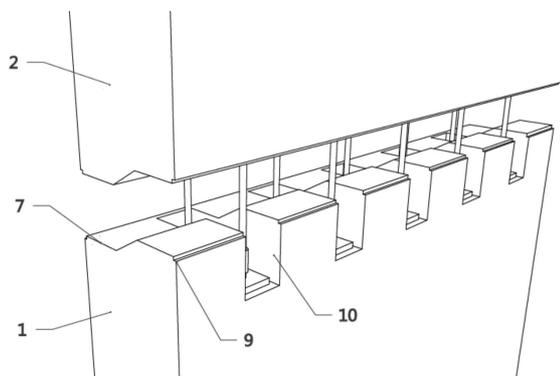
1. 一种预应力拼接的装配式剪力墙,其特征在于,包括至少两块预先制作并用于沿竖向拼接的预制墙体;预制墙体上沿竖向开设有多个上下贯通并用于贯穿预应力钢筋的预留灌浆孔道,预应力钢筋依据预留灌浆孔道的排布方式对应布置,预应力钢筋一一对应贯穿预留灌浆孔道,并且预应力钢筋从预留灌浆孔道的上端外露;预留灌浆孔道内灌注有用于使预应力钢筋与预制墙体有效黏结并共同传递预应力的现浇浆料;底层预制墙体的预应力钢筋的底端与底部受力构件锚固,相邻的两块预制墙体紧贴布置,相邻的两块预制墙体的预应力钢筋通过预应力专用连接器连接,相邻的两块预制墙体的预留灌浆孔道上下对应并且内部的现浇浆料相连,相邻的两块预制墙体之间的连接部位开设有打胶口,在打胶口内打上用于防水和避免灌浆流出的弹性密封胶。
